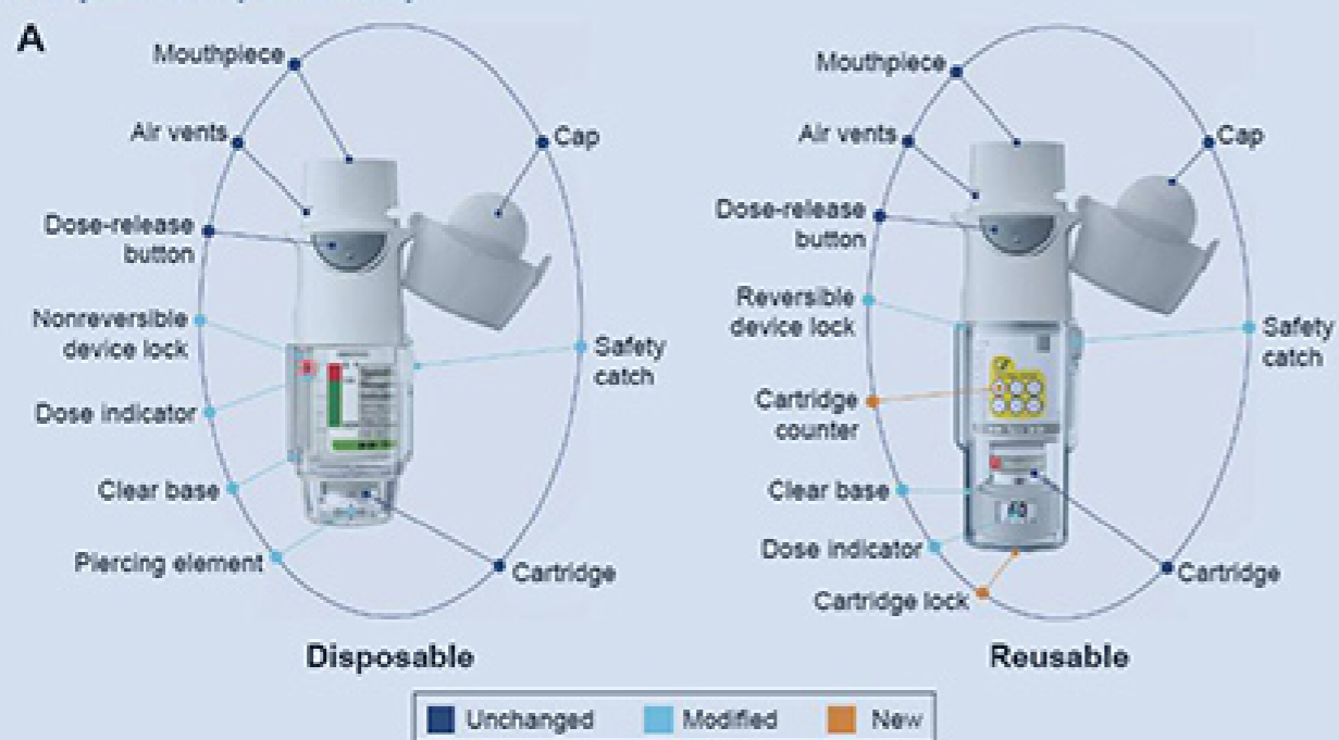
Figura 1. Características del diseño de Respimat ® : Dispositivo actual (desechable) y nuevo dispositivo (reusable) 6
